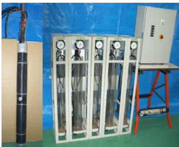
写真-1 5連セルとポンプ
